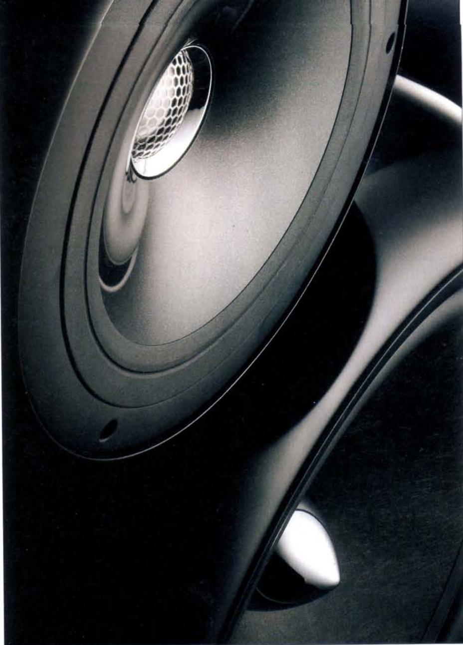
Die Form macht's: Mitteltöner, Sicke und Kopfteil beeinflussen die Richtwirkung des Hochtons und sind deshalb völlig kantenlos gestaltet. Unten rechts der massive Grundtöner.
