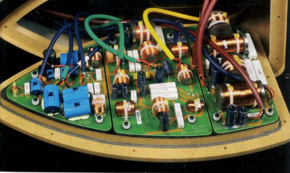
**Maximalismus:** Die Weiche der 207/2 ist aufwendig bestückt und sorgt auch für eine weitreichende Entzerrung. Lohn der Mühen ist ein völlig glatter Frequenzgang.
